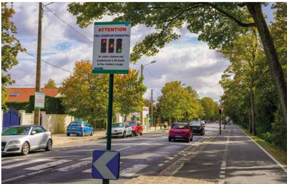
Un "feu à récompense" a été implanté avenue de la Résistance, à l'angle de la rue Corneille. Son principe : il reste au rouge et passe au vert dès qu'un véhicule est en approche et respecte la limite de vitesse.
